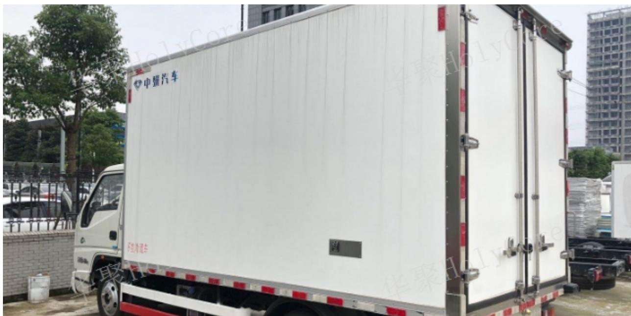
冷藏车装货时不能将货物堆得太高，一定要保证装货高度不高于出风口的平面高度。因为，如果出风口前面被货物挡住或离货物太近，不但会影响货物的储运温度，还会影响冷冻机组的正常工作。由于出风口被货物堵塞，冷气（或热气）不能正常在车厢内循环，因而使货物局部温度升高。另一方面，由于冷冻机组的除霜设计采用空气感应除霜的方式，当货物与出风口太近时，机组蒸发器内的盘管会快速结霜（或冰），空气感应开关随即运作，机组会迅速进入除霜状态，而当温度回升至9℃时，除霜又立即结束，这样循环往复的除霜操作，会导致厢体内温度降不下来，加大设备的耗损。要知道，冷藏车的制冷机组不是用来降低货物温度的，而是维持货物温度的。当外界的冷（热）源通过辐射、传导、对流到厢体内，被制冷机组吹出的冷气带走，才能隔绝热源进入货物。因此在装货时，必须先测量所装货物的温度。如果制冷机组的设定点温度高于或低于货物温度，车厢内的货物温度就很难达到需要的温度。而货物的储存温度与运输温度必须一致，如
