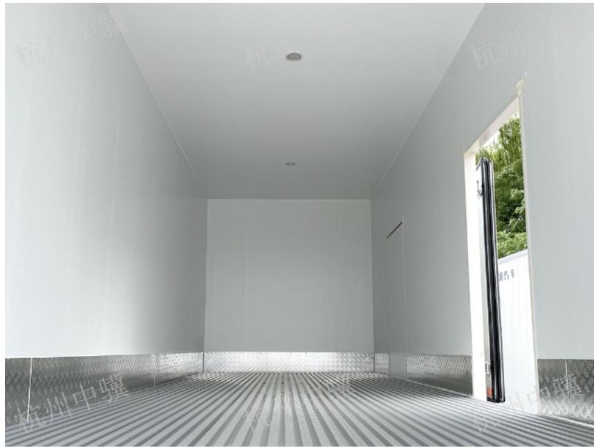
一款合适的运输冷藏厢货车该如何选择，关于保温厢体：目前我们的保温厢体制作主要有以下三种材质：1、内外彩钢板2、外饰铝合金内饰彩钢板3、内饰彩钢板外饰玻璃钢，其中开始用的多也是便宜的一种。另外，保温层的厚度也分为5cm和8cm两种。关于冷藏机组：对于冷藏机组的选择需要根据您的具体需求来定。目前冷藏机组从-5度-18度均有。如果您只是运菜作保鲜，那么一般选用-5度左右的机组就够了。如果是运冷冻食品就可以选用-12到-18度左右的机组。另外越大的厢长就需要选用制冷量越大的机组。制冷量越高的机组降温越快。另外机组也有国产的进口的区别，两者在价格上面的差别较大，这个可以根据您的具体需求来定。关于肉钩车：现在有不少客户用冷藏车拉冷鲜肉，需要在车厢内加装肉钩。目前我们的冷藏车都可以加装肉钩，肉钩可以根据您的需求来加装，一般可装3排4排或5排。我们的导轨为铝合金材质，肉钩为不锈钢材质。整车出具：正规底盘合格证，正规整车合格证，正规车辆购置税发票，全国统一机动车，随车工具，车辆质保手册，车辆使用说明书，全国服务站名录等。让您上户无忧，方便快捷！
